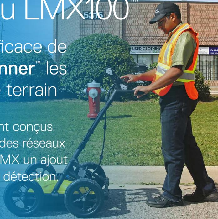
Les GPR LMX complètent les détecteurs de câbles et de canalisations traditionnels et vous permettent de localiser et de positionner :
