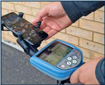
对精确的公用设施地图的需求正在迅速增长。RD8200 精密管线仪可与外部 GNSS 系统（例如 Trimble Catalyst 和 RD MAP+）连接，以提供厘米级精度的地图。
