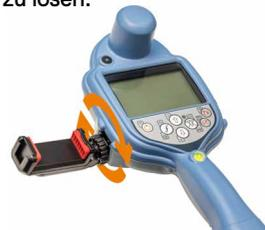
3. Drücken Sie die rote Taste an der Smartphone-Halterung, um die Klemmung zu öffnen und legen Sie das Mobiltelefon in die Fassung ein. Drücken Sie die Klemmung zusammen, um das Smartphone zu fixieren.
