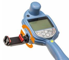
3. Appuyer sur le bouton rouge du support pour téléphone pour déployer le support et placer votre téléphone dans le support. Serrer fermement pour fixer le téléphone en place.
