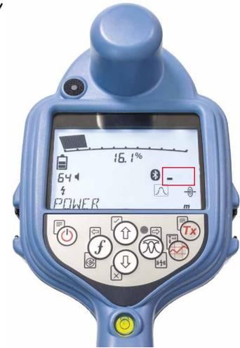
Figure 1a. Le récepteur à la recherche de satellites
