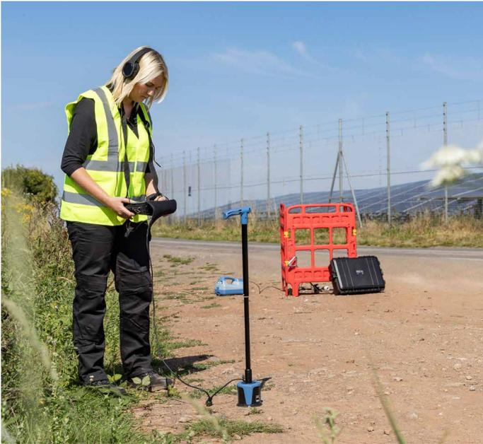
Fortschrittliche Sensor-Technologie lässt den RD510 Lecks in einer Tiefe von bis zu 5 Metern präzise erfassen.
