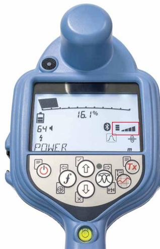
Abbildung 1b. Empfänger erkennt Satelliten.
