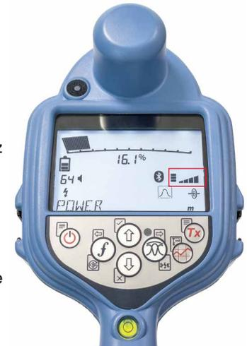
Abbildung 1b. Empfänger erkennt Satellit.
