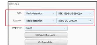
8. Klicken Sie auf das Dropdown-Menü neben „GPS“ und wählen Sie „Radiodetection“ aus. Klicken Sie dann auf das rechte Dropdown-Menü und wählen Sie das GNSS-Bluetooth-Modul aus, welches mit RTK-82SG beginnt.
