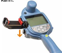
2. Sobald diese am Platz ist, drehen Sie im Uhrzeigersinn am Rad, um sie zu sichern, oder gegen den Uhrzeigersinn, um sie zu lösen.
