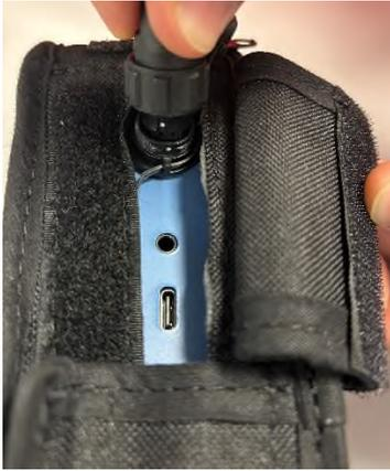
Figura 4.4 Conector del sensor acústico
