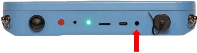
Figura 2.10: Toma de audio de la unidad de visualización RD510
