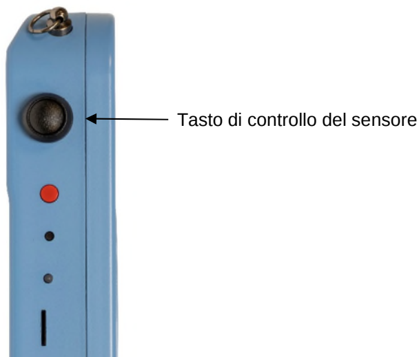
Figura 2.18 Attivazione del sensore acustico del localizzatore RD510
