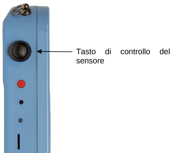
Figura 2.20: Attivazione del sensore acustico del localizzatore RD510
