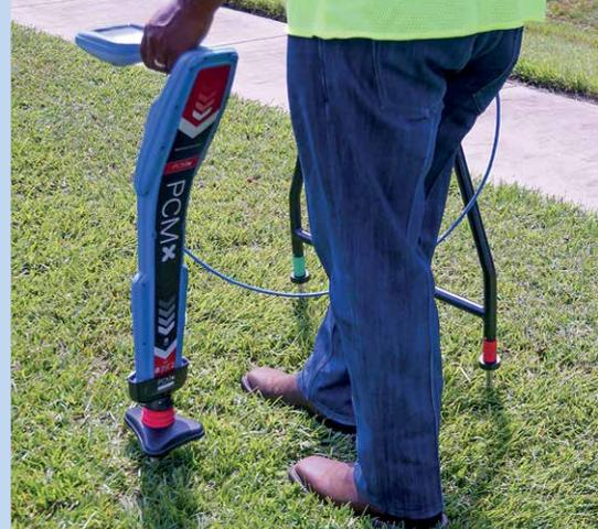
Les mesures de positionnement en une seconde combinées à l'obtention simultanée des données ACCA et ACVG accélère les contrôles.
