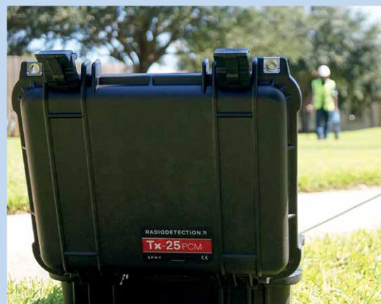
Le Tx-25PCM, un générateur avec un courant de sortie de 1 A alimenté par une batterie rechargeable.
