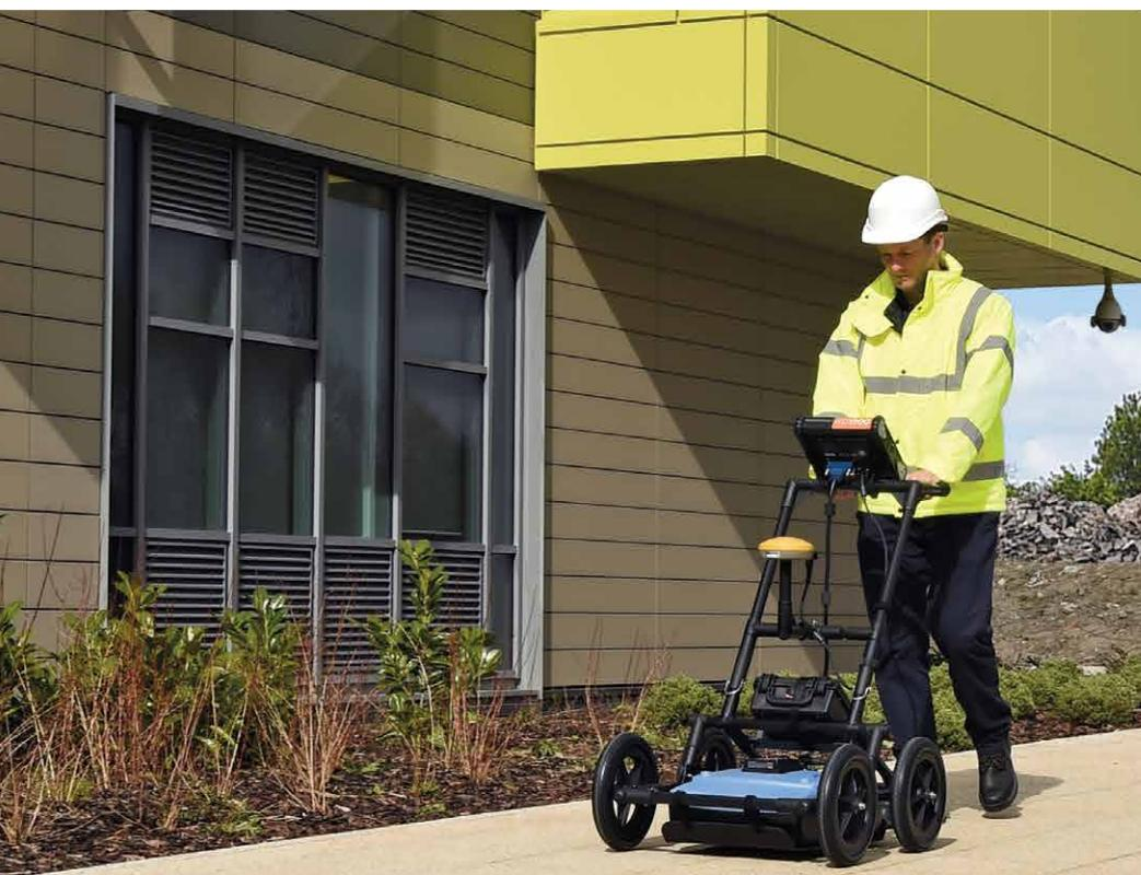
**RD1100** bietet Ortungsexperten, Vermessern und anderen Nutzern das passende Werkzeug, um die Position aller Arten von Kabeln und Leitungen, einschließlich solcher aus Kunststoff und Keramik, zu bestimmen und zu markieren. Die Möglichkeit, Screenshots im internen Speicher zum sofortigen Versenden per E-Mail über WLAN oder zum späteren Exportieren auf einen USB-Stick zu speichern, ist als Standard integriert. Die GPS-Position wird für die Integration in Google Earth™ erfasst.
