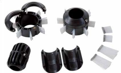
Chaque système P340 flexiprobe est livré avec un kit universel de brosses et patins faciles à adapter qui permet d'utiliser la caméra de 25 mm (1") dans des canalisations d'un diamètre maximal de 100 mm (4") et d'utiliser la caméra de 50 mm (2") dans des canalisations d'un diamètre maximal de 150 mm (6"). Chaque jeu de brosses se remplace facilement en quelques secondes. D'autres équipements de série peuvent varier selon les pays.
