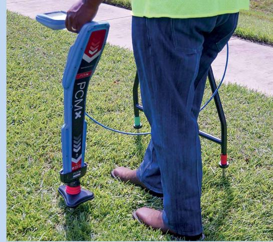
**Mediciones de trazado de un segundo combinadas con recopilación simultánea de datos ACCA y ACVG para una inspección más rápida.**
