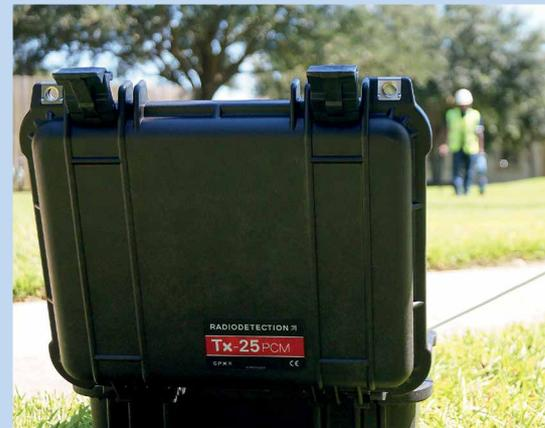
**Tx-25PCM, transmisor de señal de salida de 1 Amp que ofrece la flexibilidad de una batería recargable.**
