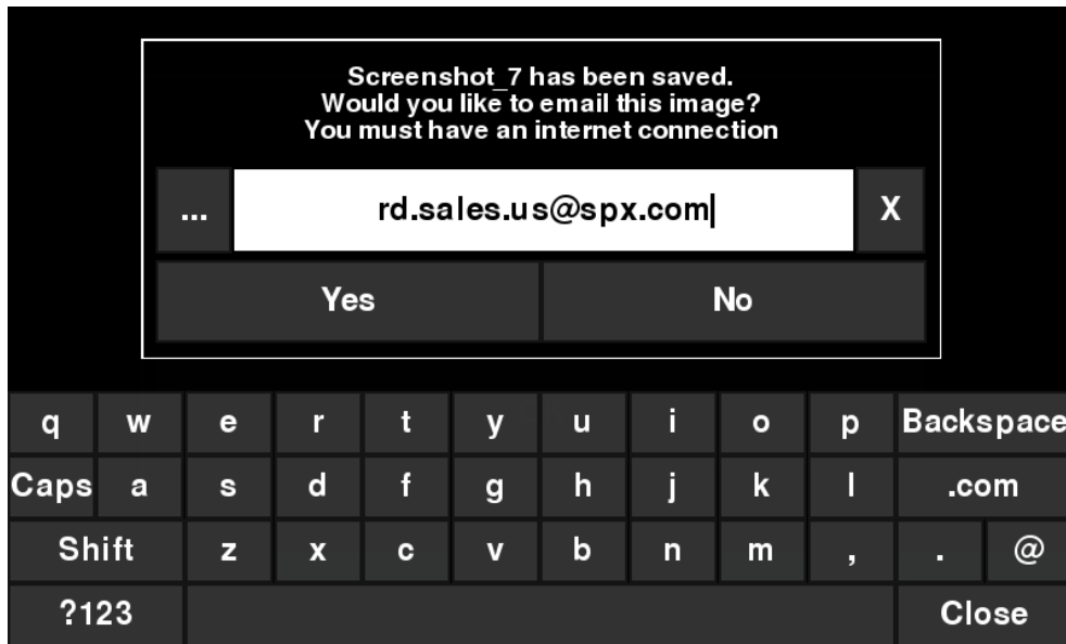
图 7-2: 按显示单元上的相机 (Camera) 按钮截取屏幕后显示的消息 (已启用 WiFi 并连接到无线网络)。用户可输入微型报告的收件人电子邮件地址
