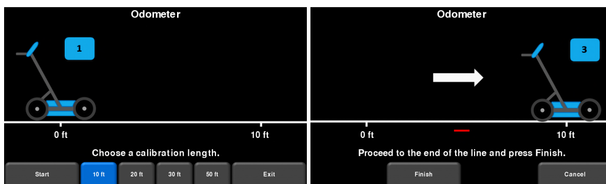
Figuur 6-13: odometertest. De afbeelding links toont het scherm waar de gebruiker een afstand moet selecteren. De afbeelding rechts vraagt u die afstand te bewegen en op Beëindigen te drukken.
