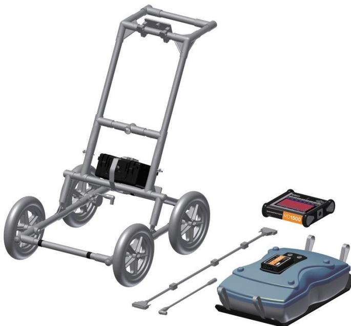
Fixez l'antenne au radar à l'aide des sangles. Assurez-vous que l'antenne est orientée dans la bonne direction et que les raccords sont à l'arrière du radar. À l'aide des sangles, ajustez la
