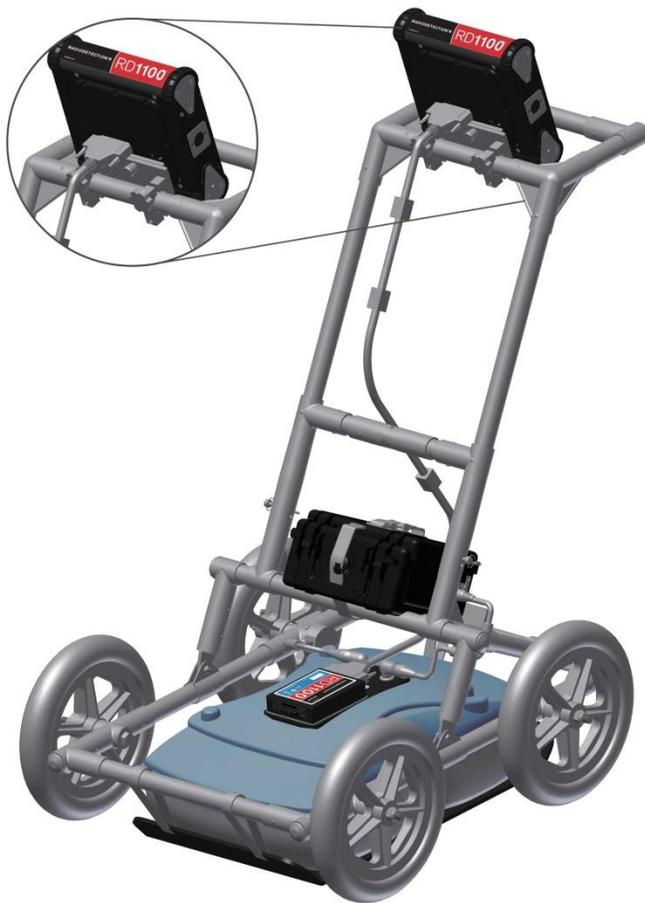
Branchez les câbles de la batterie et de l'odomètre. Branchez le câble de l'odomètre sur la prise la plus proche de l'antenne. Branchez le câble d'alimentation à l'antenne et à la batterie. Le système est désormais prêt à être utilisé.
