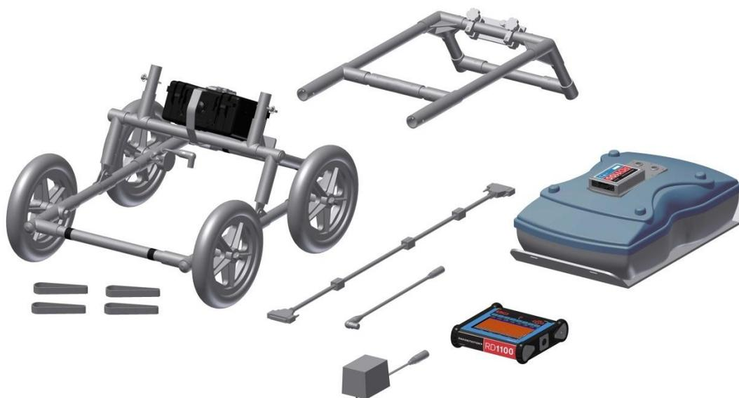
Fixez le guidon sur le châssis du radar à l'aide des goupilles. Assurez-vous que le support de l'unité de contrôle fait face à l'opérateur.
