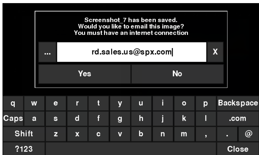
图 12-2: 按显示单元上的相机 (Camera) 按钮截取屏幕后显示的消息 (已启用 WiFi 并连接到无线网络)。用户可输入微型报告的收件人电子邮件地址。
