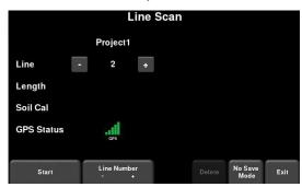
Pulsar el botón **Inicio** para comenzar a recopilar los datos. La pantalla cambiará a la pantalla de adquisición de datos. Mientras se empuje el sistema a lo largo de una línea recta, los datos obtenidos del GPR se desplazarán en la pantalla de derecha a izquierda.
