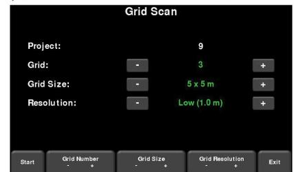
Richten Sie das System so aus, dass die Längsachse auf der ersten Linie zentriert wird. Dann richten Sie die Mitte des Sensors auf die Startlinie aus und drücken **Start**. Schieben Sie das System in einer geraden Linie in Richtung Linienende.
