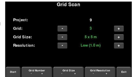
Alignez le système de manière à ce que l'axe longitudinal soit centré sur la première ligne. Alignez ensuite le centre de l'antenne sur la ligne de départ et appuyez sur Démarrer. Poussez le radar en ligne droite jusqu'à la fin de la ligne. Le système cesse automatiquement de recueillir des données lorsque vous arrivez à la fin de la ligne. L'image de balayage des données recueillies apparaît à gauche de l'écran.
