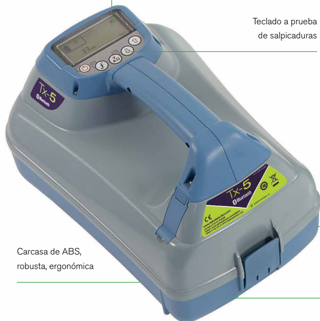
Alimentado por 8 pilas de NiMH o alcalinas LR20 (D) o por un paquete de baterías recargable opcional
