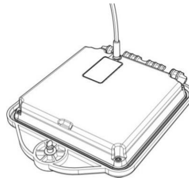
Abbildung 4.13 Aufladen des Li-Ionen-Akkupacks des Senders
