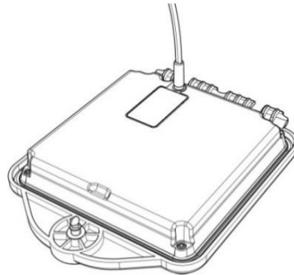
Afbeelding 4.13 De Li-ion batterijen van de zender laden
