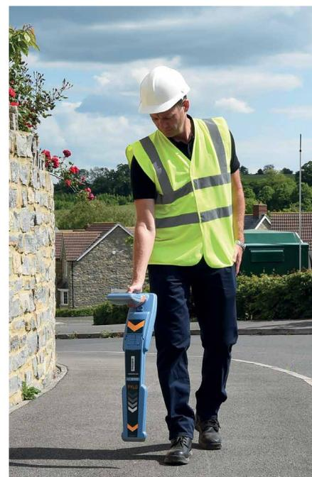
El RD8100, nuestra gama de localizadores de precisión más avanzada, se construye en base a este pedigrí de rendimiento, calidad y durabilidad. Contiene una disposición exclusiva de 5 antenas, lo que permite elegir el nivel óptimo de precisión para el trabajo que realiza. Las opciones de registro de uso y GPS integrado generan automáticamente los datos para los informes de los clientes, o a las auditorías internas de calidad y seguridad para promover mejores prácticas de trabajo.
