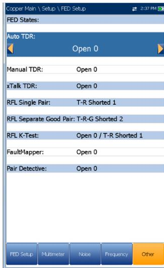
Auf der Registerkarte **Sonstige** werden die **FED-Standardstatus** für alle anderen Tests angezeigt. Die **FED-Status** für die folgenden Tests werden aufgelistet:
