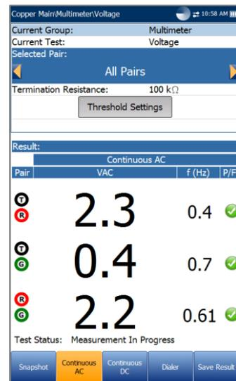
**Dauer-AC** und **Dauer-DC** werden synchron ausgeführt. Drücken Sie auf dem Tastenfeld auf Start/Stop, um den Test auszuführen.
