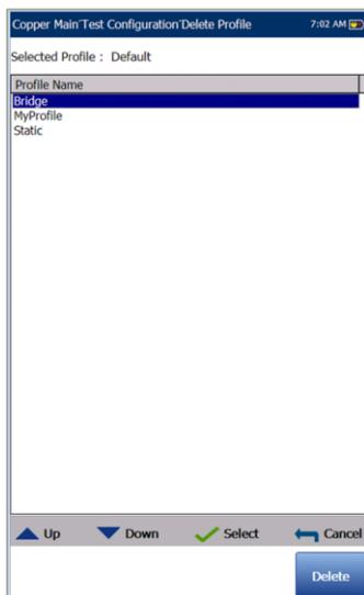
Mit **Profil löschen** werden alle im internen Speicher gefundenen Profile (mit Ausnahme des Standardprofils, das nicht entfernt werden kann) aufgelistet.
