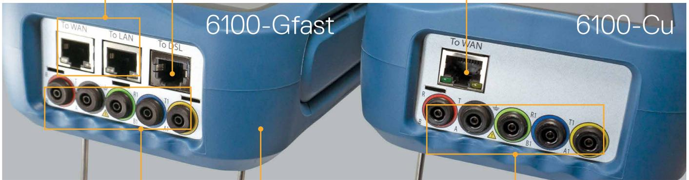
Bananenbuchsen, unterstützen G.fast/DSL- und Kupferkabel-Tests
