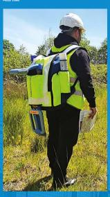
外部护套带有魔术贴,可轻 松稳固地托住任何精密定 位仪
