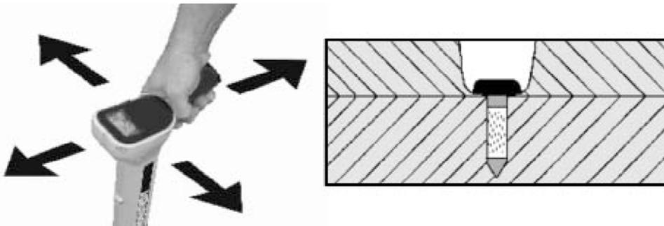
图 13: “X”形移动可实现精准定位
