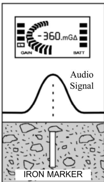
图 11： 铁质物体范围内的视觉指示图示
