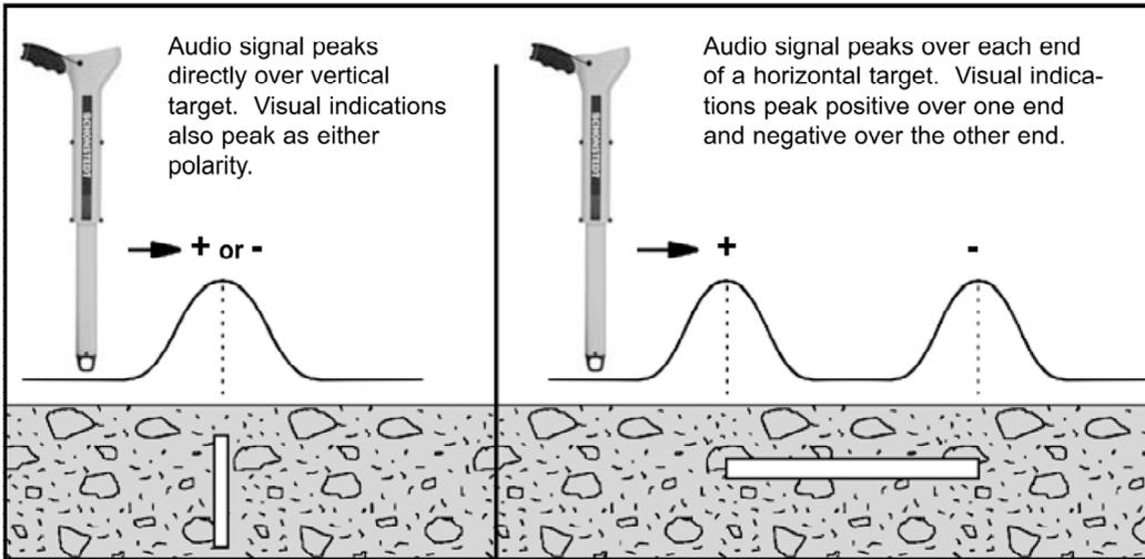
图 12: 垂直目标和水平目标的信号
