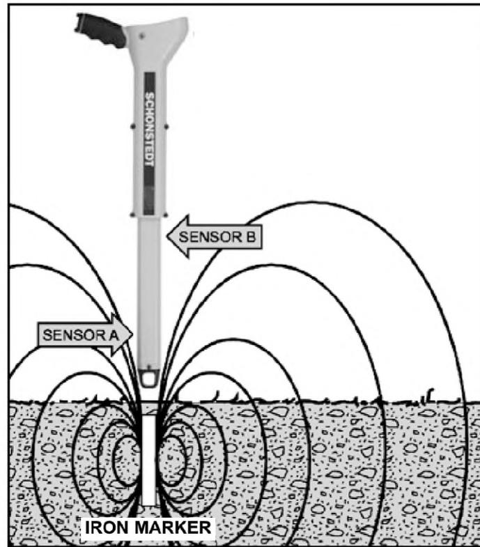
图 1： 探测铁质标示物的磁场
