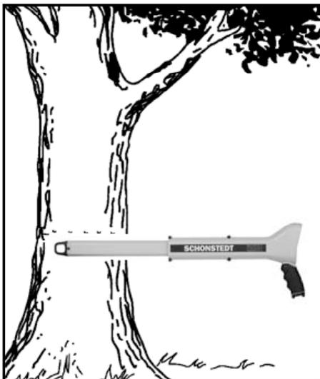
检查树木的基准点和嵌入式带刺铁丝。握住定位仪，使其与铁丝的方向平行。
