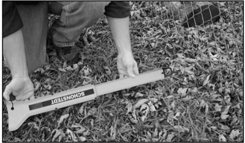
沿围栏缓慢向前移动定位仪进行搜索，同时还需左右移动设备。随着您向前移动，这种技巧能让您搜索到几英尺宽的区域。当定位仪末端 3.8 厘米的底部传感器位于标桩的正上方时，您会听到信号突然减弱（如图 23 所示，信号减弱为零）。定位仪的位置发生任何变化都会产生突然增强的信号频率。
