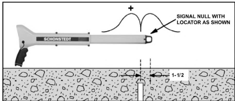
图 23: 沿铁丝网围栏搜索时信号突然减弱
