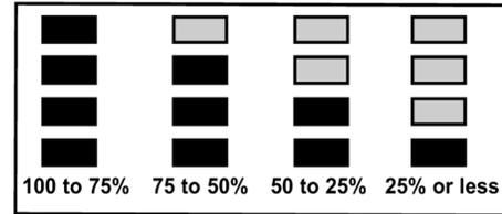
图 5： 电池电压状态指示器
