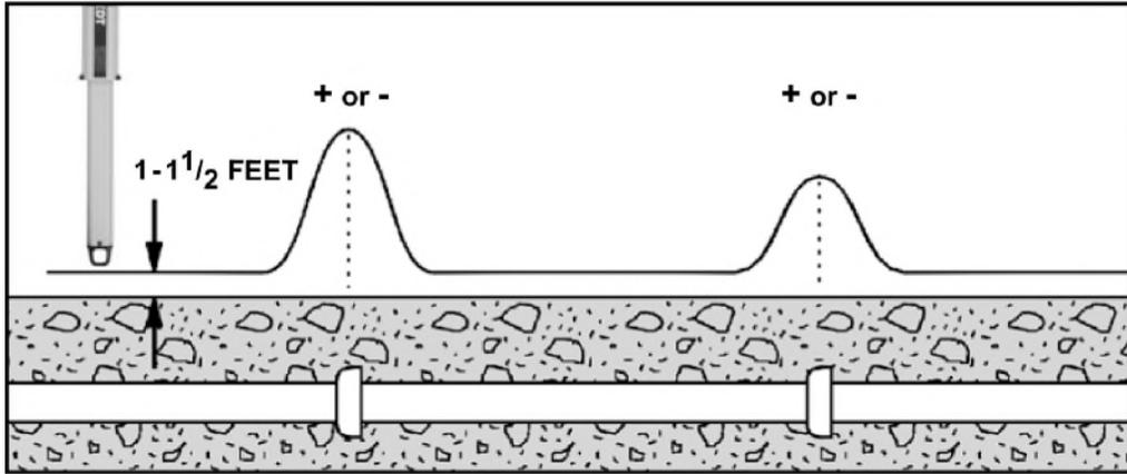
图 25: 铸铁管产生的信号模式
