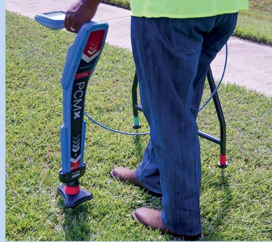
**Mapping-Messungen im Sekundentakt in Verbindung mit gleichzeitiger ACCA- und ACVG-Datenerfassung beschleunigt Untersuchungen.**
