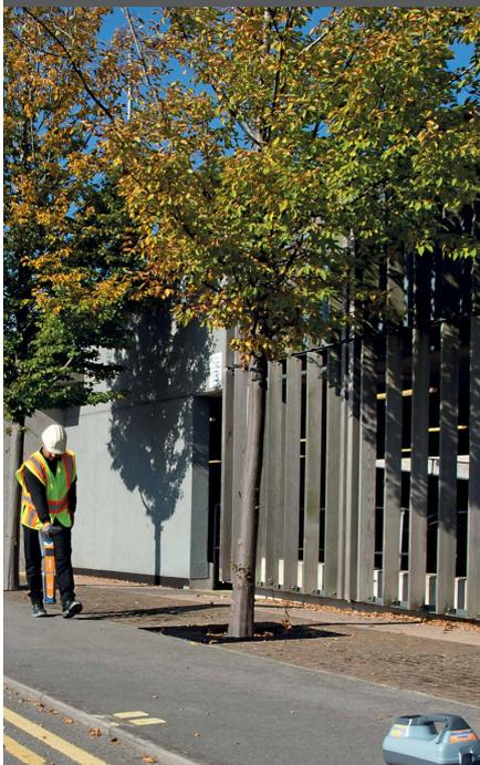
Ensemble de détection de précision utilisant un ensemble de fréquences actives, passives et de sonde, ciblant spécifiquement les besoins des utilisateurs dans les métiers de l'eau. Le mode guidage contribue à localiser de manière conviviale un réseau avec des guides visuels et audio, alors que la fonction iLOC™ permet le contrôle à distance du générateur avec son récepteur.
