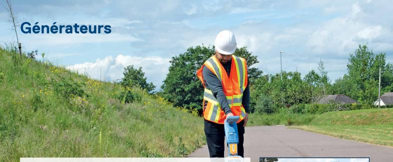
L'utilisation d'un générateur est essentielle pour identifier et suivre les réseaux enterrés, car elle donne le contrôle à l'opérateur.
