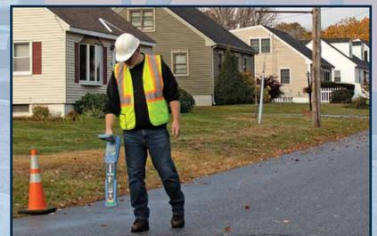
Defekte an Kabelabschirmungen können mit Hilfe des 8-kHz-FF Mantelfehlersuche mit einer Rahmenantenne von Radiodetection auf 10 cm (4") genau geortet werden.
