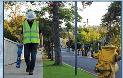
Rohre mit kathodischem Korrosionsschutzsystem (KKS/CPS) können mit dem CPS-Modus passiv verfolgt werden. Der Modus CPS-Kompass gewährleistet korrekte Ausrichtung auf den Zielverlauf.
