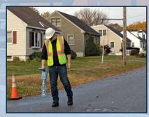
Los fallos de revestimiento del cable pueden localizarse con una precisión de 4" (10 cm) con el modo búsqueda de averías de 8 kHz mediante el bastidor en A de Radiodetection.
