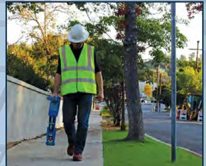
带有阴极保护系统的管道可以使用 CPS 被动模式进行跟踪。CPS 罗盘模式可确保与目标管道对齐。
