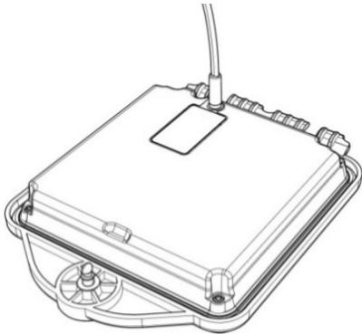
Figura 4.13 Carga de las baterías de Li-Ion del transmisor
