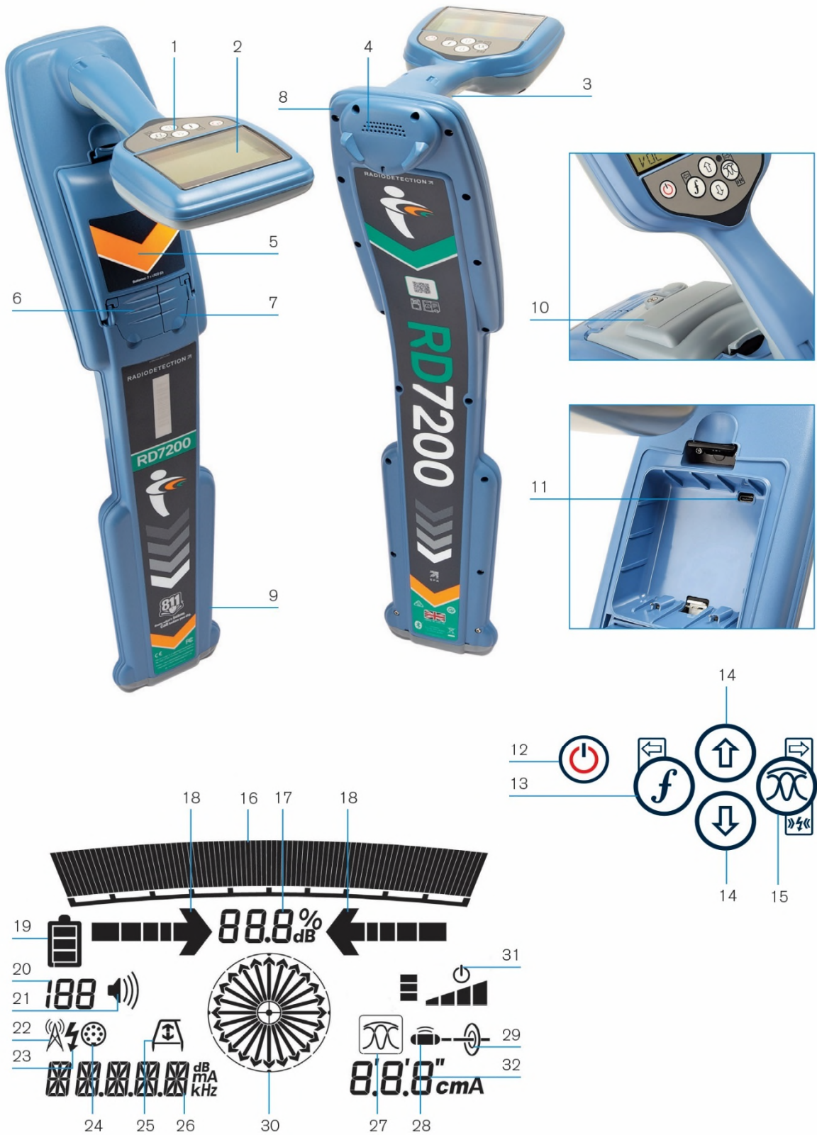
الشكل 3.1: جهاز تحديد أماكن كابلات وأنابيب المرافق RD7200
