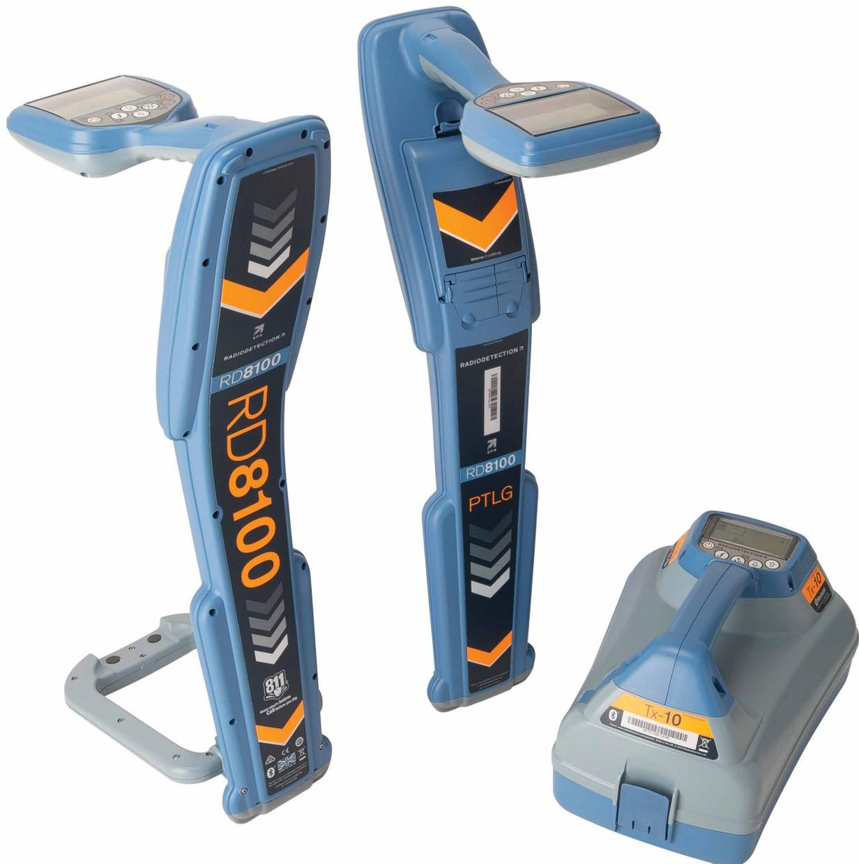
Radiodetection brachte vor über 40 Jahren den ersten kommerziellen Ortungsempfänger für Kabel und Rohrleitungen mit Doppelantenne auf den Markt. Seitdem haben wir Pionierarbeit bei der Entwicklung zahlreicher Technologien geleistet, die heute weit verbreiteten Einsatz in der Ortungsbranche finden. Hinter Entwicklungen wie Tiefenmessung, StrikeAlert™ und Current Direction™ steht unser Bestreben, Infrastruktur vor Schäden zu schützen und Ausschachtungen zu erleichtern und sicherer zu machen.
