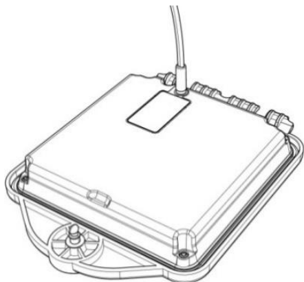
Figure 4.13 Chargement du bloc batterie li-ion du générateur
