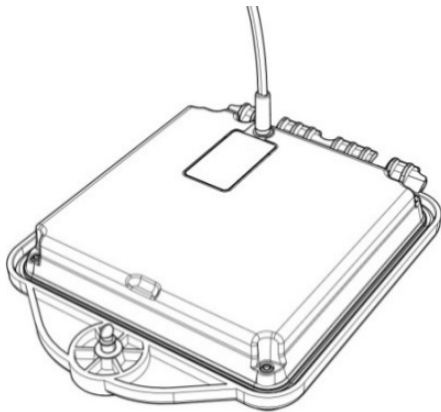
Figura 4.13 Carga de las baterías de Li-Ion del transmisor
