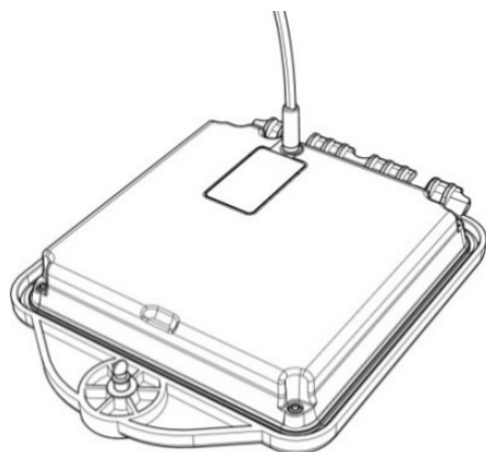
Afbeelding 4.13 De Li-ion batterijen van de zender laden
