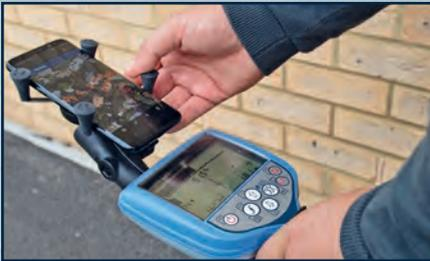
La demanda de mapas de servicios públicos precisos está creciendo rápidamente. El localizador de precisión RD8200 se puede conectar con sistemas GNSS externos, como el Trimble Catalyst y RD MAP+ para entregar mapas con precisión de centímetros.
